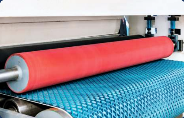
EN LA DIRECCIÓN DE ALIMENTACIÓN SE UTILIZA UN RODILLO DE PRESIÓN DE POLIURETANO, RESISTENTE A LOS IMPACTOS Y CON UNA VIDA ÚTIL MÁS LARGA.
