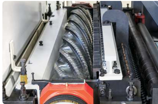
El nuevo diseño de viga de presión minimiza el sobre corte en los extremos de las placas
